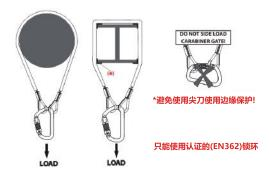
锚固装置方向为垂直。锚固装置静强度最小为 12kN。 最大动态性能强度为 9kN
